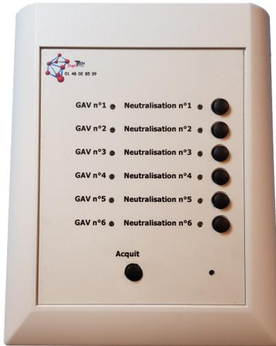
Boitiers d'alerte de localisation et d'inhibition pour 6 cellules de garde à vue.
